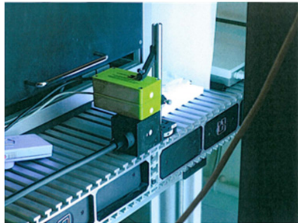
Fig. 4. – Banc d'étalonnage des spectroradiomètres UV à matrice de photodiodes fonctionnant avec un luminaire à tubes fluorescents.
