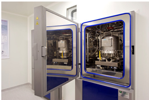
Fig. 2. – Photographie de l'ensemble générateur de débit.
