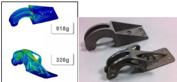
Fig. 2. – Exemple d'optimisation topologique d'une charnière réalisée en FA (société Multistation pour Airbus Group Innovations).
