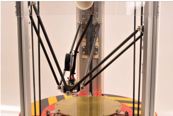
Fig. 14. – Photographie d'une imprimante de FA utilisant un des procédés de la catégorie « extrusion de matière » (société Spiderbot, fabricant français). Dans ce cas de figure la tête d'impression est montée sur un système hexapode et la plateforme de fabrication est fixe.
