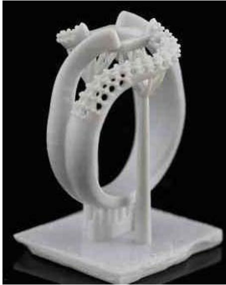
Fig. 6. – Bague et supports réalisés en ABS par un procédé de la catégorie « photopolymérisation en cuve par lampe avec un photomasque » (société Delta Technologie).
