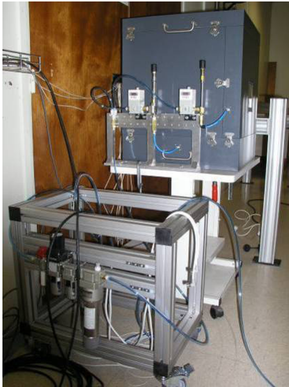
Fig. 4. – Système de refroidissement par circulation d'air utilisant des tubes Vortex. Au premier plan les différents filtres pour l'air comprimé du réseau, en amont des deux régulateurs de pression et des deux tubes Vortex au second plan devant l'enceinte du calorimètre (de couleur grise).
