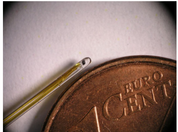
Fig. 6. – Extrémité d'une sonde de température. La thermistance de mesure (perle noire) est visible à l'extrémité du capillaire en quartz.
