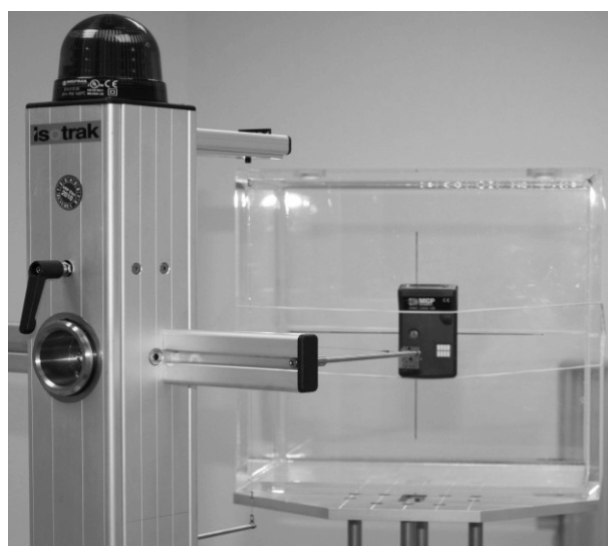
Fig. 8. – Dispositif d'étalonnage de dosimètre électronique individuel sur fantôme – plaque ISO à 30°.
