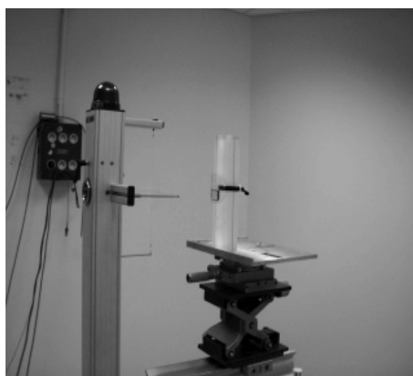
Fig. 9. – Dispositif d'irradiation de dosimètre poignet passif sur fantôme – colonne ISO.
