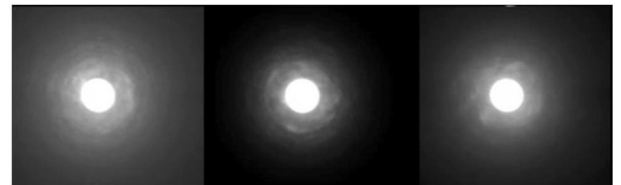
Fig. 7. – Clichés de diffraction CBED de la couche ultra-mince métallique.
