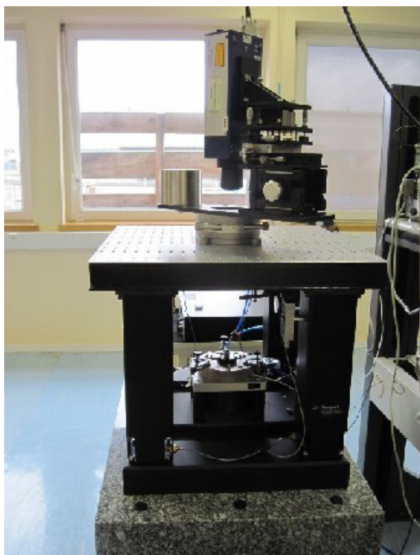
Fig. 6. – Photographie de l'excitateur E2911 et de sa table isolée.
