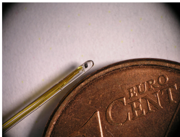
Fig. 4. – Extrémité d’une sonde de température en quartz.
