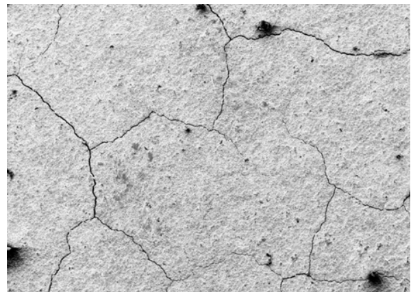
Fig. 6. – Micrographie MEB du revêtement d'oxyde de chrome après chauffage à 900 °C (grossissement \times 25 ).
