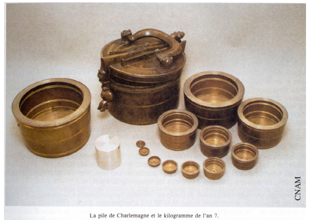
Fig. 1. – Une pile de Charlemagne et le kilogramme en platine de l'an 7 (1799).
