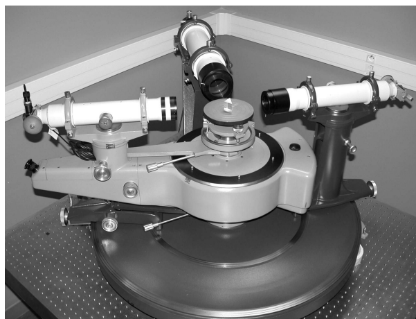
Fig. 6. – Goniomètre pour la mesure absolue de l'indice de réfraction.
