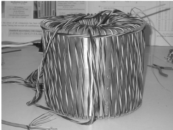
Fig. 4. – Enroulement secondaire du transformateur d'isolement.
