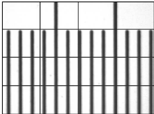
Fig. 7. – Repère de référence permettant l'alignement du micromètre objet ; un trait du micromètre représente dans cette configuration 25 pixels (objectif de grandissement 50).
