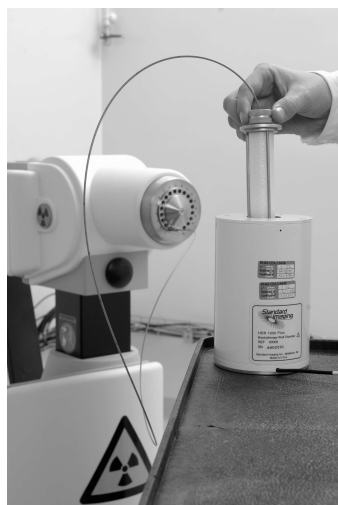
Fig. 10. – Chambre d'ionisation à puits Standard Imaging HDR1000+ (projecteur de source en arrière plan).
