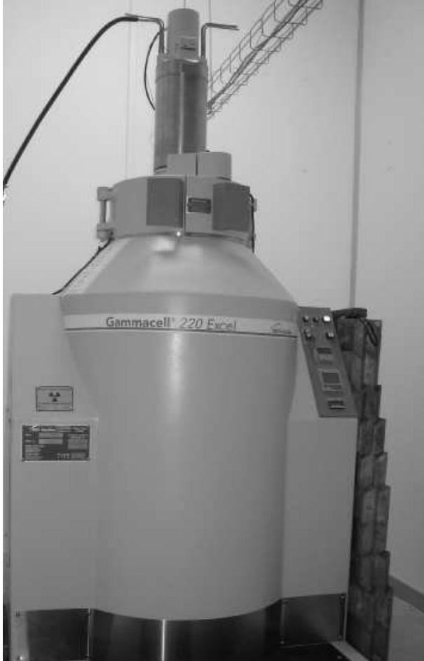
Fig. 4. – Irradiateur GammaCell, permettant de réaliser des irradiations aux ^{60}\text{Co} allant d'une dizaine de grays jusqu'à 100 000 Gy.
