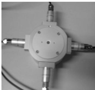
Fig. 2. – Détecteur constitué d'une sphère intégratrice et de quatre petites photodiodes InGaAs.
