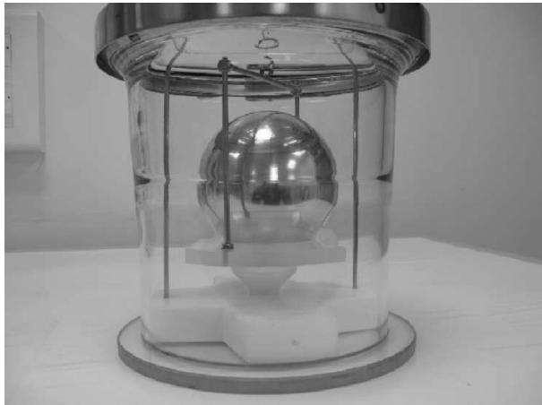
Fig. 2. – Vue partielle du réacteur avec une sphère positionnée sur la nouvelle suspension.
