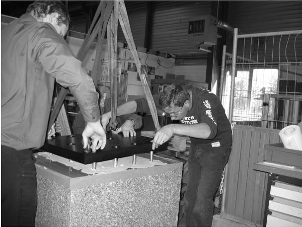
Fig. 5. – Dépose de la plaque d'interface de l'excitateur sur le nouveau massif sismique de 1 200 kg.
