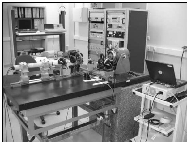
Fig. 2. – Vue d'ensemble de la référence nationale en vibration sinusoïdale transférée au LNE.
