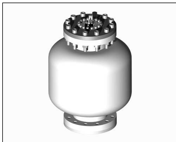
Fig. 3. – Vue CAO du dispositif à ouverture rapide moyenne pression (DOR40).
