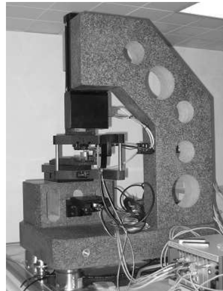
Fig. 4. – Vue générale du banc de mesure des états de surface.
