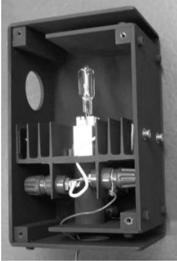
Fig. 5. – Vue de l'intérieur de la lanterne contenant la lampe tungstène halogène de référence.
