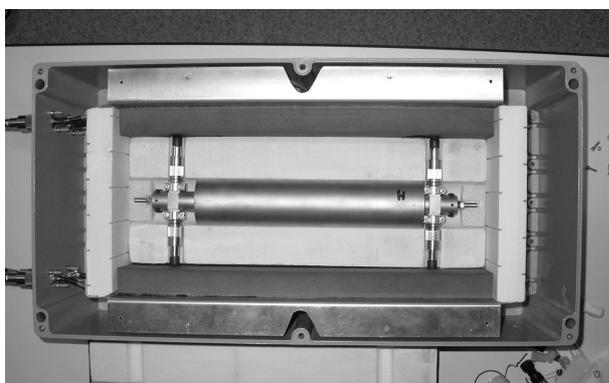
Fig. 1. – Nouvelle résistance calculable de Haddad.
