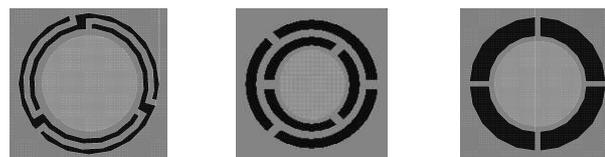
Fig. 3. – Conception des trois structures MEMS à base de membrane silicium à partir d'un *wafer* SOI.
