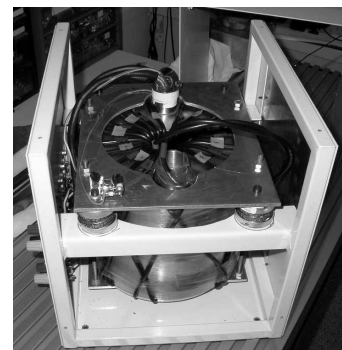
Fig. 3. – Nouveau transformateur de tare.
