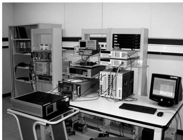
Fig. 5. – Dispositif de mesure constituant le wattmètre numérique à échantillonnage.
