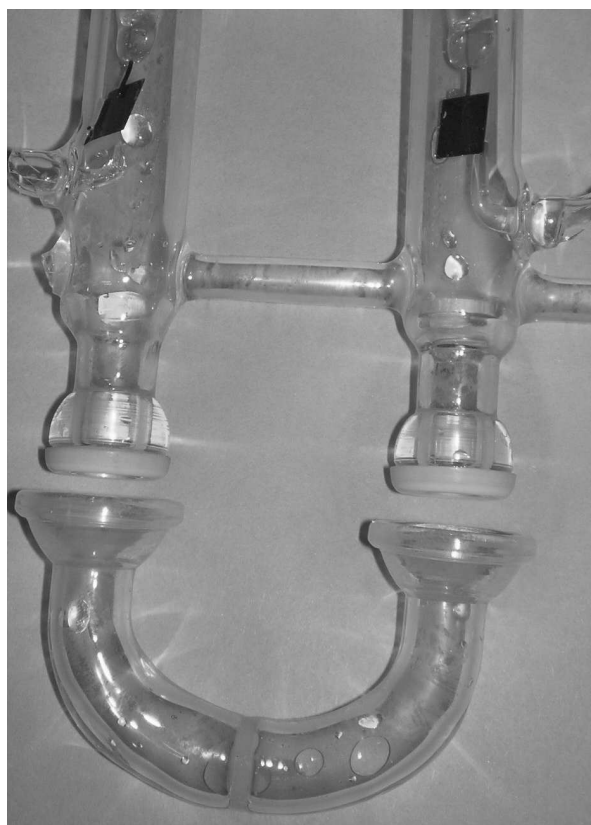
Fig. 5. – Partie en U amovible contenant le fritté de la cellule secondaire de pH.
