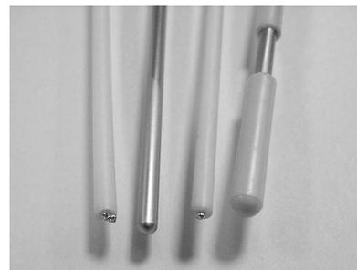
Fig. 3. - Couples thermoélectriques mis en œuvre avec les cellules eutectiques développées ; de gauche à droite : couples Pt-Pd, W-Re gaine Ta, type B, W-Re gaine Mo muni de son fourreau en  $ZrO_2-8\%Y_2O_3$ .
