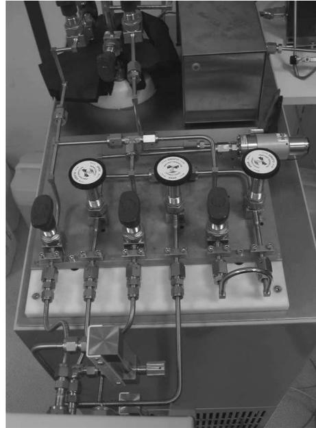
Fig. 6. - Vue du générateur « basse température » ; au premier plan, circuit de distribution.
