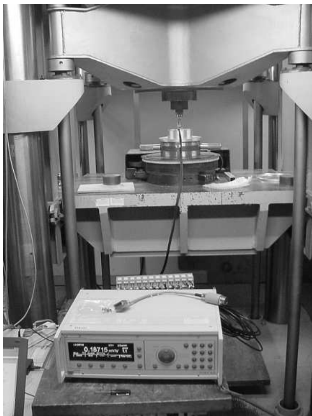
Fig. 4. - Eprouvette sollicitée en compression sous le banc de référence de 500 kN.
